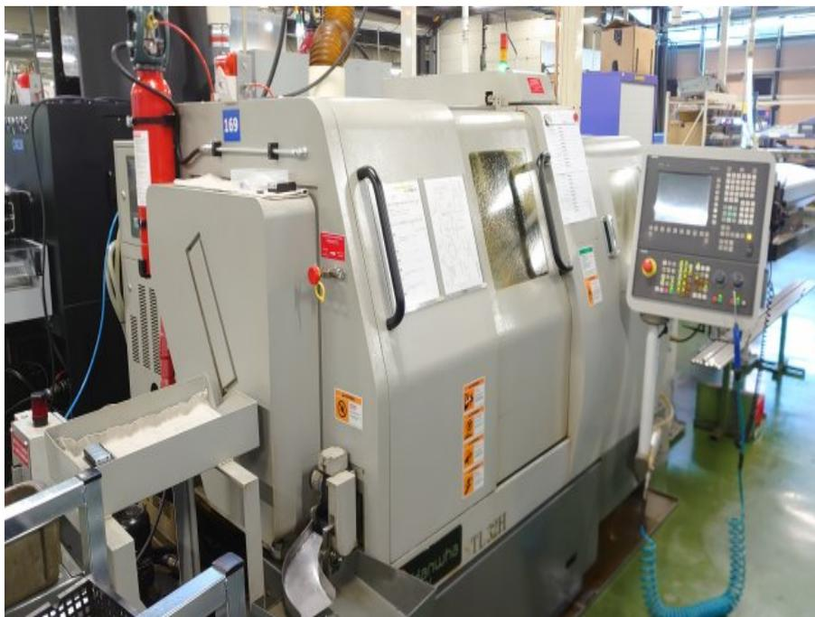
Machine équipée avec la double motorisation sur la tourelle
