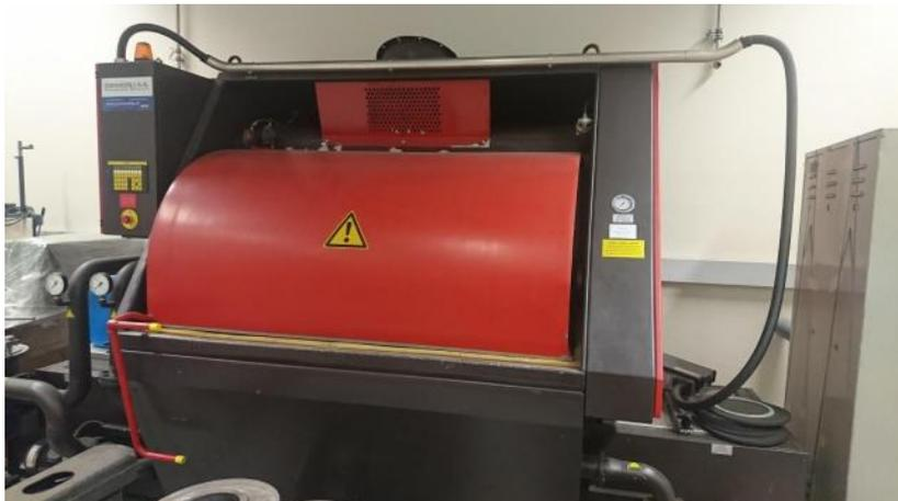
Machine de nettoyage en milieu aqueux par aspersion
