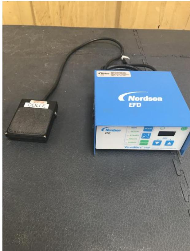
Le contrôleur Valve Mate 7100 assure le contrôle principal de la taille de la dépose.
