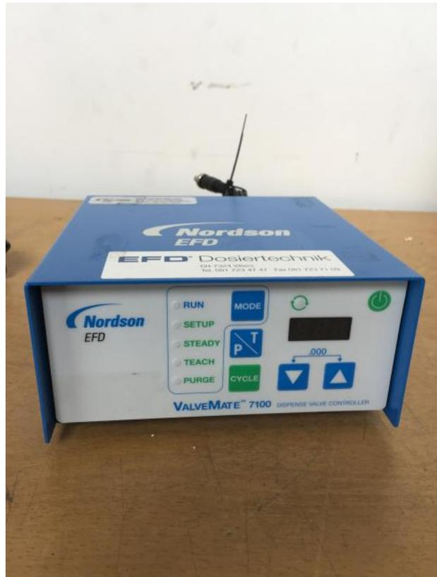
Ces contrôleurs assurent le contrôle principal de la taille de la dépose. ils sont conçus pour apporter un contrôle de la dépose de fluide au plus près de la valve de dosage et offrent de nombreuses options ergonomiques qui simplifient le montage et le fonctionnement de la valve.
