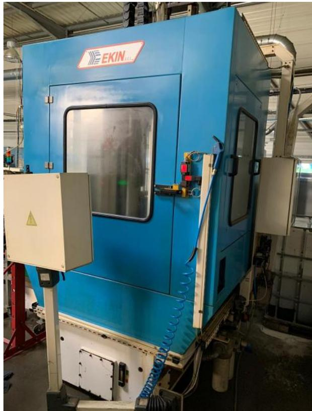
MACHINE À BROCHER LES INTÉRIEURS À DÉPLACEMENT DE TABLE
